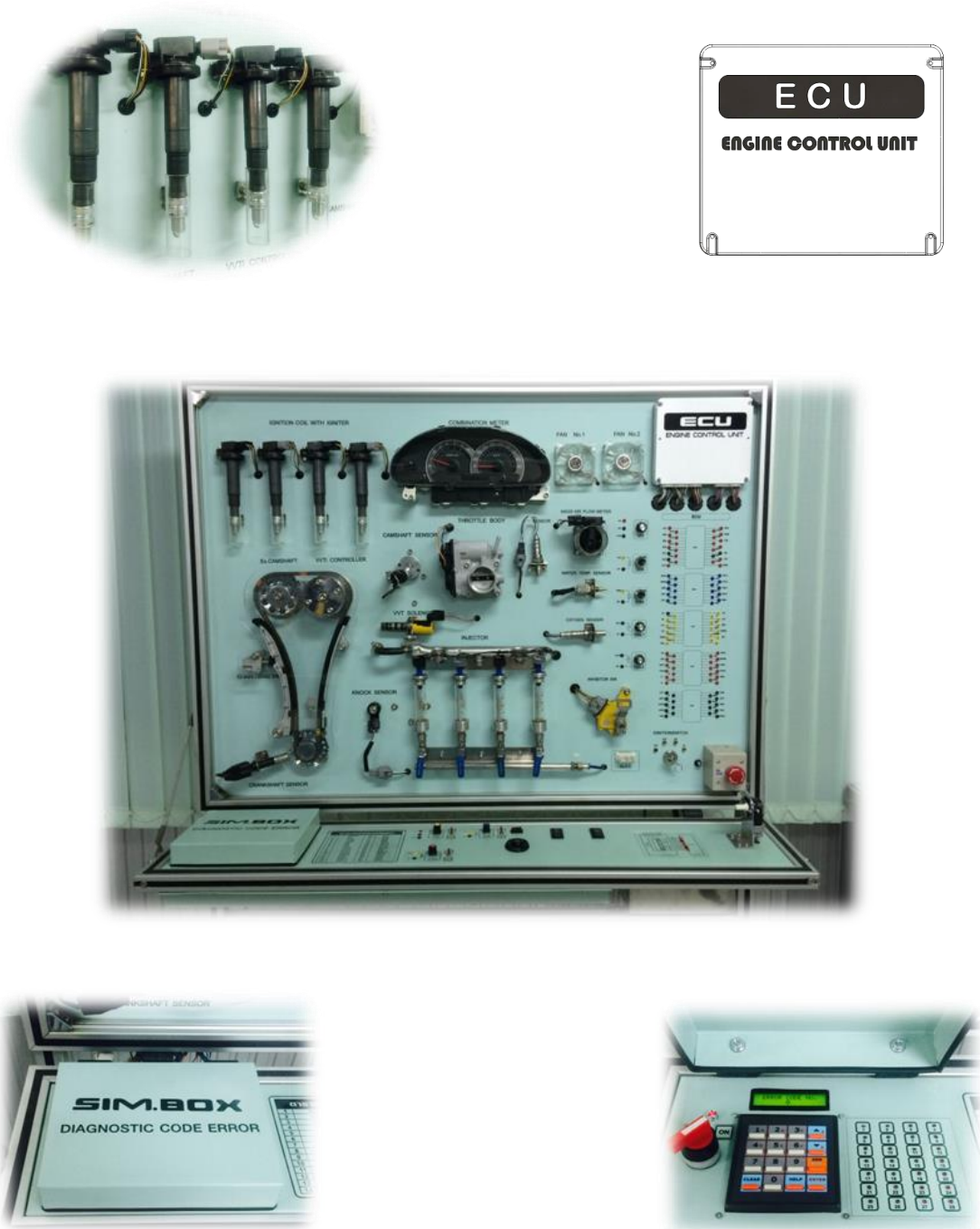
ภาพที่ 3-10 ชุดฝึกระบบเครื่องยนต์แก๊สโซลีนควบคุมด้วยอิเล็กทรอนิกส์ที่เสร็จสมบูรณ์
